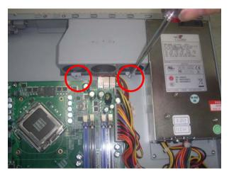
Step 2: Lift up the fan module aside
