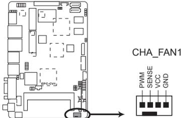
**EPC-CV1 Chassis fan connector**
