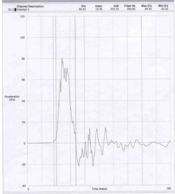
ASTECH MACHINE DROP HEIGHT: 36 INCHES SIDE DOWN :BOTTOM DROP NO : 6 TEST ID : AMB-2003
