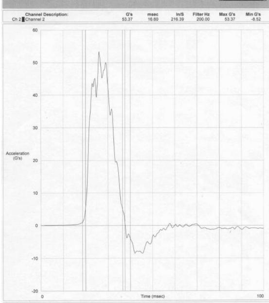
ASTECH MACHINE DROP HEIGHT: 36 INCHES SIDE DOWN: LEFT DROP NO: 2 TEST ID: AMB-2003
