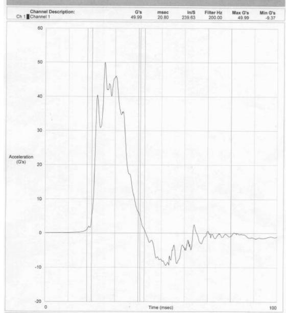
ASTECH MACHINE DROP HEIGHT: 36 INCHES SIDE DOWN :BACK DROP NO : 4 TEST ID : AMB-2003
