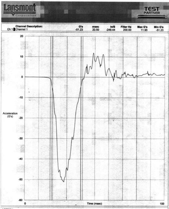
ASTECH MACHINE DROP HEIGHT: 36 INCHES SIDE DOWN :FRONT DROP NO : 3 TEST ID : AMB-2003
