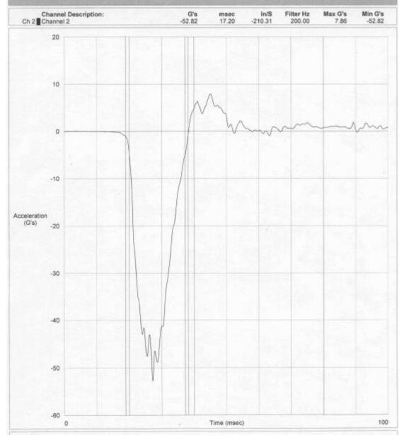
ASTECH MACHINE DROP HEIGHT: 36 INCHES SIDE DOWN :RIGHT DROP NO : 1 TEST ID : AMB-2003
