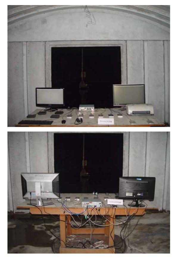
**RADIATED EMISSION TEST**
