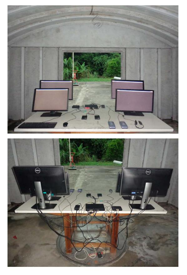
**RADIATED EMISSION TEST**
