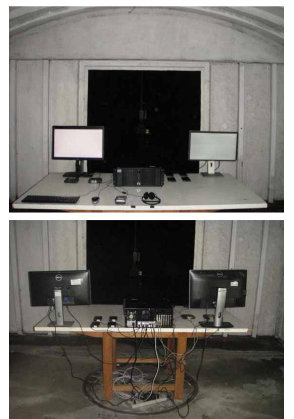
**RADIATED EMISSION TEST**
