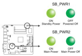
**EMB-BT1 Onboard LEDs**
