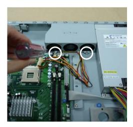
Step 4: Lift up the fan module aside
