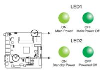
**EMB-BT7 Onboard LEDs**
