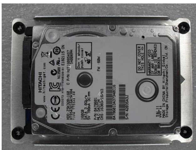
2. 将硬盘和固定架叠在一起，并使用十字起子锁上螺丝将他们固定
